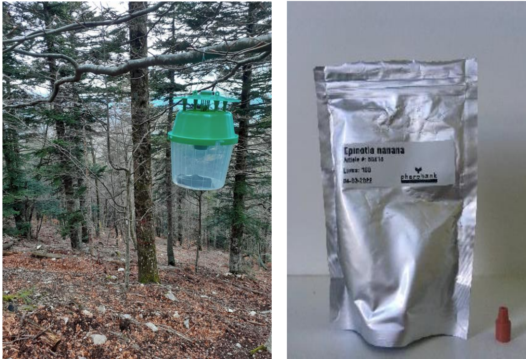
Figure 2. Piège Funnel trap en sapinière (Mont Ventoux) et diffuseur à phéromones sexuelles de types « lures » (Pherobank, référence '50414'). Photos : INRAE
