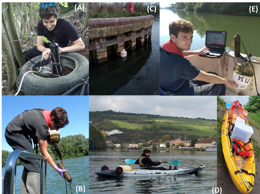
Figure 5. Installations matérielles : (A) montage des hydrophones dans les affluents peu profonds ; (B) mouillage de l'hydrophone dans le chenal ; (C) ancrage latéral en entrée d'écluse ; (D) moyens nautiques ; (E) relevé données des stations d'écoute
