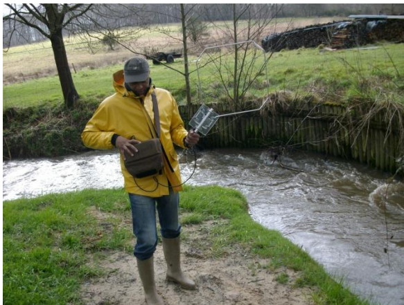
Figure 58 – Matériel utilisé pour le suivi manuel : boîtier de détection portatif et antenne boucle.
