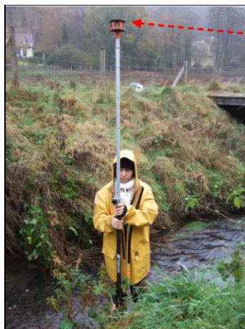
Figure 11 – Les divers points de mesures du levé topographique réalisé à l'aide du tachéomètre.
