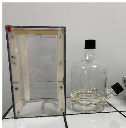
Figure 13 : Photo de l'ancienne enceinte en plexiglas et du prototype 1 en verre
