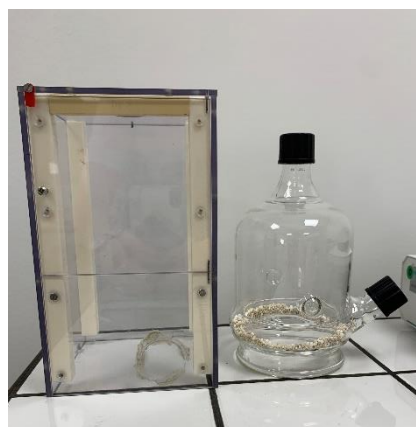
Figure 13 : Photo de l'ancienne enceinte en plexiglas et du prototype 1 en verre
