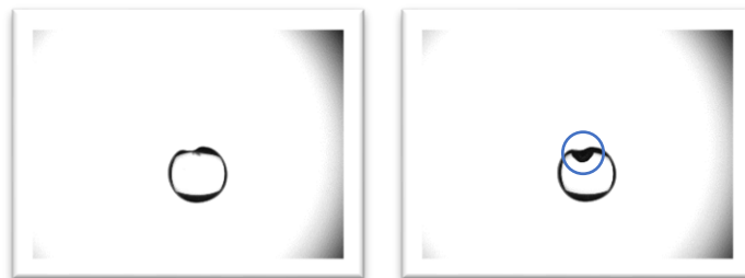
Figure 8 : Aspect d'une goutte de WPI 18% à t = 27 min et t = 28 min. La vacuole apparaît à t = 28 min
