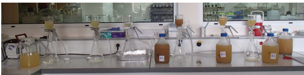
Figure 11 : Banc de filtration pour le traitement des eaux de ruissellement et de drainage
