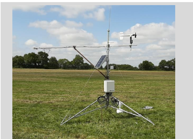
FIGURE 2 : Un albedomètre, ferme expérimentale de Derval (44).
