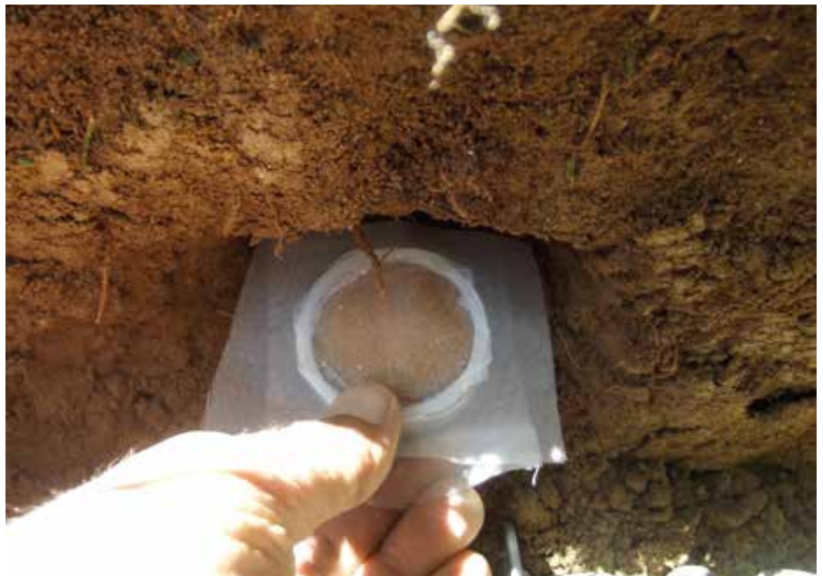
Introduction des résines échangeuses d'ions dans le sol
