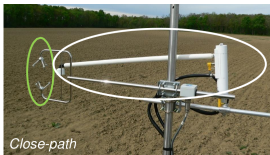
Figure 5: Instruments SAT et IRGA en système fermé. D'après T.Tallec, cours 'Intérêts des mesures de flux : la problématique bilan carbone'
