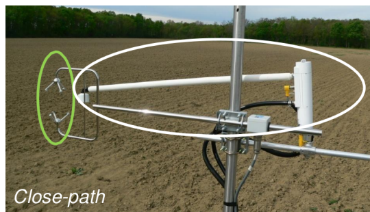
Figure 5: Instruments SAT et IRGA en système fermé. D'après T.Talleg, cours 'Intérêts des mesures de flux : la problématique bilan carbone'
