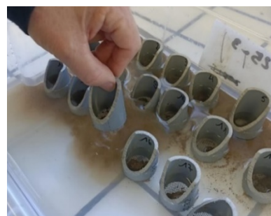
Figure 9 – Test de sédimentation, tamis support pour l'immersion des agrégats. I Breton, 2023
