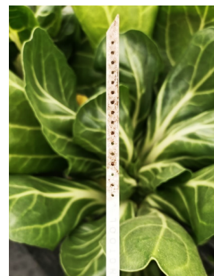
Figure 7 – Bait lamina après incubation in situ sur rangs de blettes. I Breton, 2023
