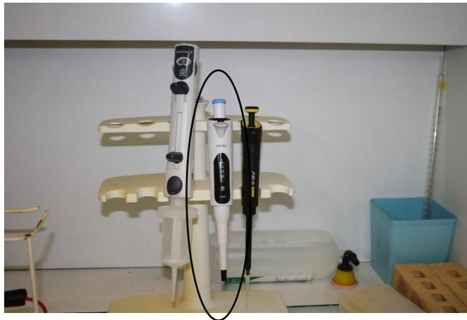
III) 5) Introduire 0,8 mL d'acide nitrique (95%) dans chaque creusets avec la pipette automatique
