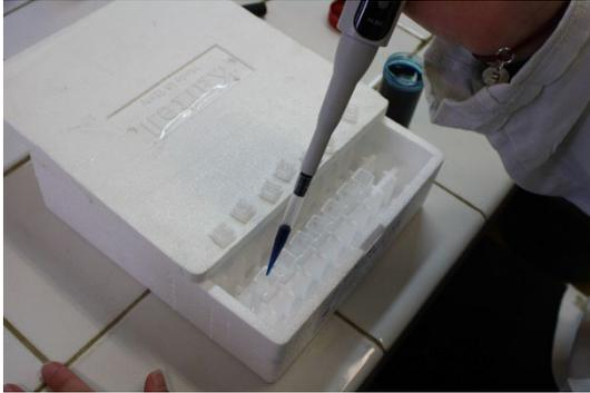
**V) 4)** Au bout des 10 min, retirer les bouchons de cuves pour ajouter 0,5 mL du réactif R2 (vert de malachite) dans chaque cuve (gamme + échantillons)
