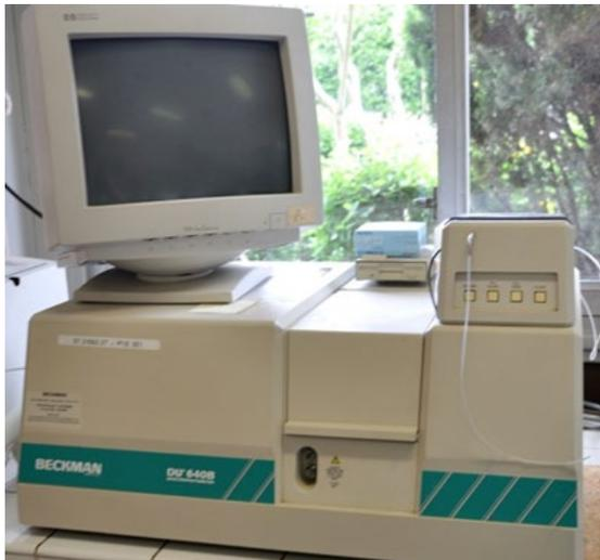
**V) 6)** Configurer le spectrophotomètre à 610 nm de longueur d'onde et mesurer tout d'abord les absorbances de la gamme (construction droite de régression), puis mesurer les absorbances des échantillons à doser.
