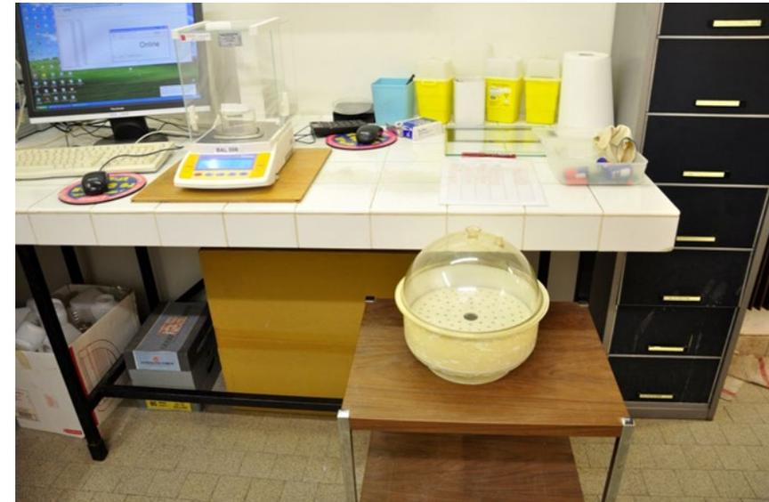
**1) 1)** Contrôle de la balance : enregistrer sur la fiche de suivi de la balance le poids des masses de contrôle avec la date et le nom de l'utilisateur
