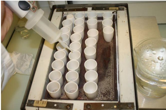
**III) 8)** Introduire 1 mL d'eau chaude dans chaque creusets et un peu plus pour les échantillons les plus évaporés.
