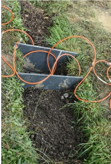
Fig. 16 Traçage géophysique dans une tranchée à broyat de bois
