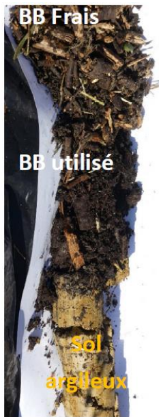
Fig. 11. Coupe verticale d'un FBB (Source : INRAE)
