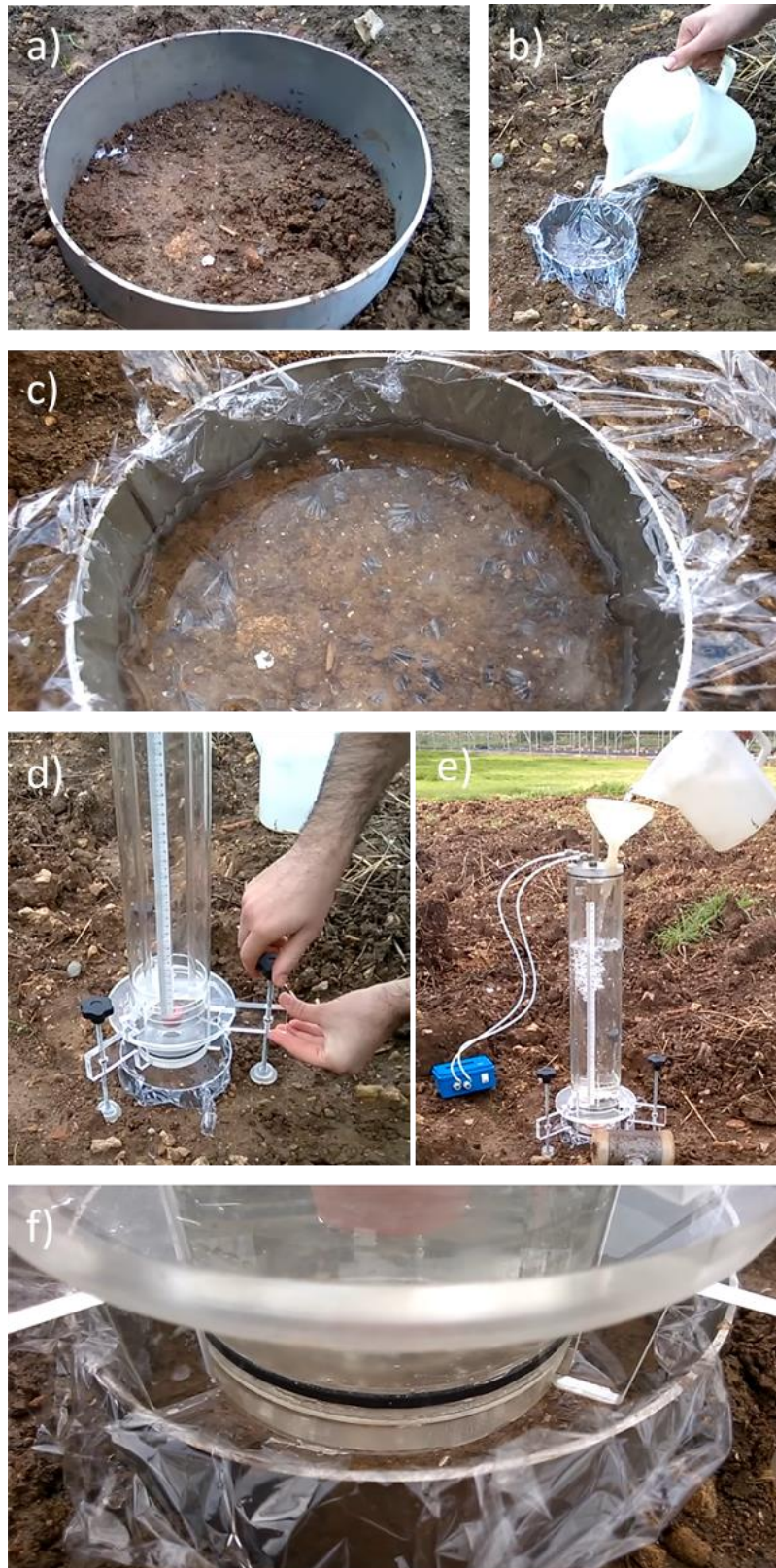
Fig. 13. Etapes à suivre pour la mise en route de l'infiltromètre automatique de type Beerkan
