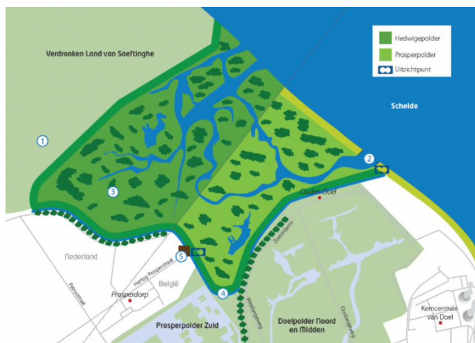
Figure 5 : Recul de digue sur l'estuaire de l'Escaut. Hedwige-Prosper polder (tiré du projet Interreg Polder2C's)
