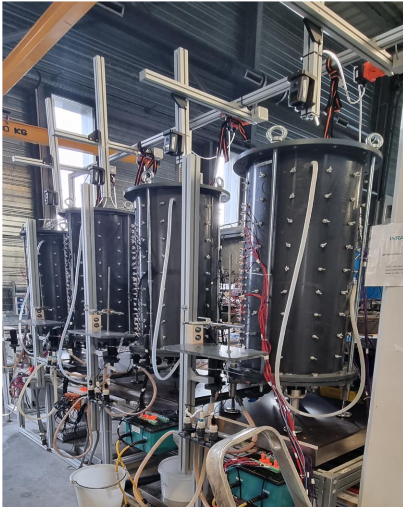
Figure 1 : pilote Matcarb composé de 4 colonnes expérimentales installées sur la plateforme Feyssine.
