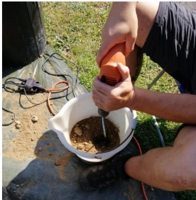
Figure 6 : opération de désagrègement du sol
