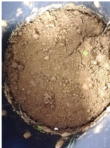
Figure 11: le sol de la colonne après une opération de saturation-désaturation
