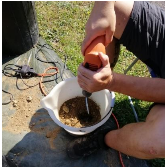
Figure 6 : opération de désagrègement du sol
