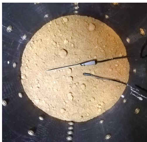
Figure 10 : sondes de température et de teneur en eau déposées sur une couche de sol
