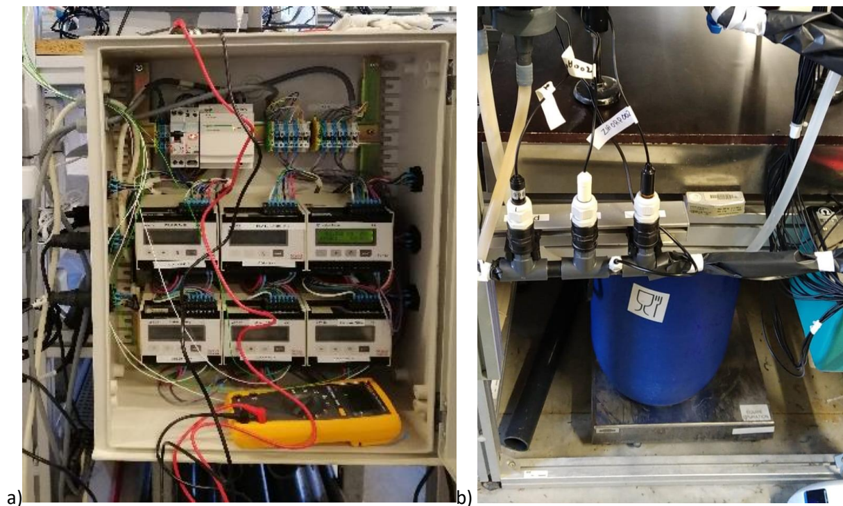
Figure 18 : a) boîtier de contrôle des balances Nobels, à gauche, b) balance Nobels de mesure du poids des eaux de sorties des colonnes, à droite.
