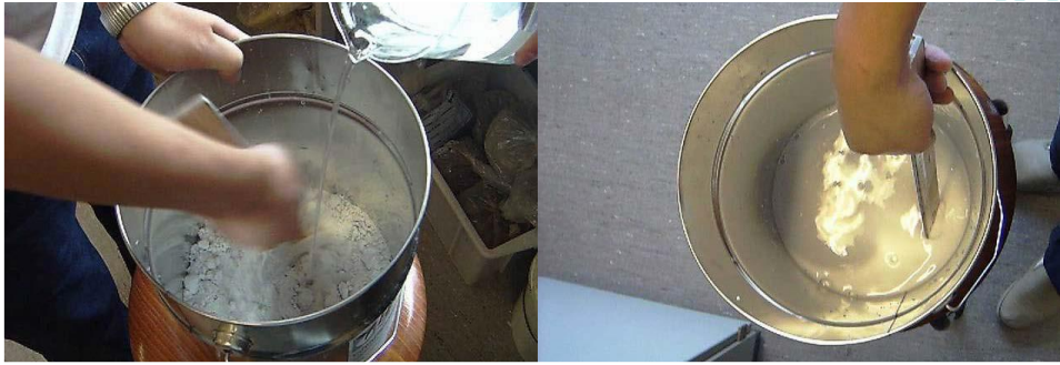
Figure 9 : mélange de sable synthétique avec l'eau déminéralisée
