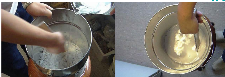
Figure 9 : Mélange de sable synthétique avec l'eau déminéralisée.
