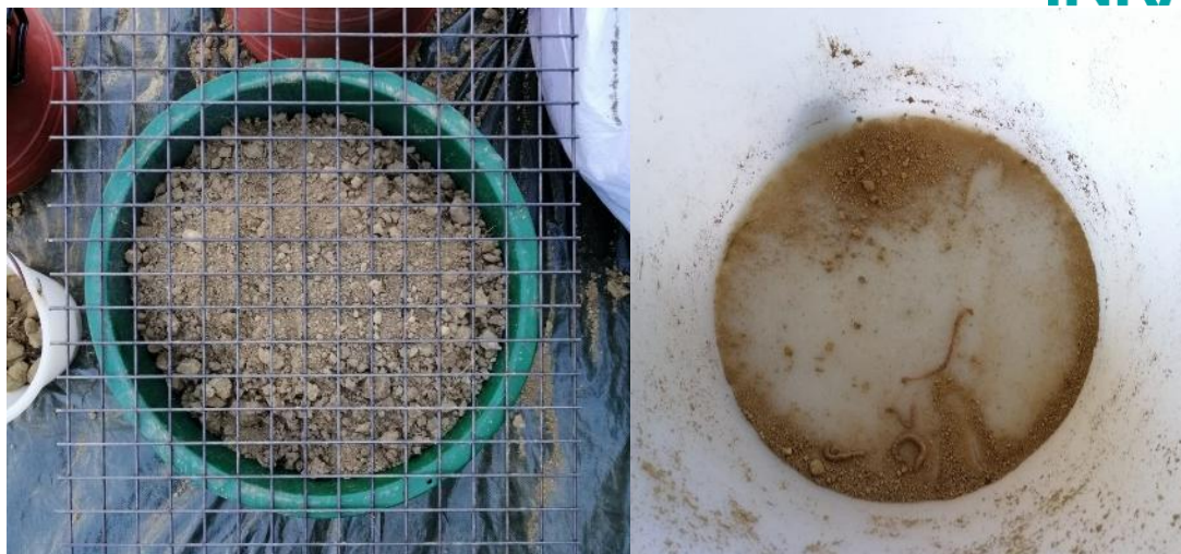
Figure 5 : A gauche, tamisage du sol par grille de maille 4 cm, à droite, macrofaune extraite manuellement.
