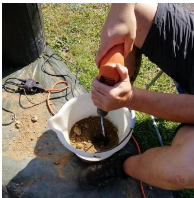
Figure 6 : Opération de désagrégement du sol.
