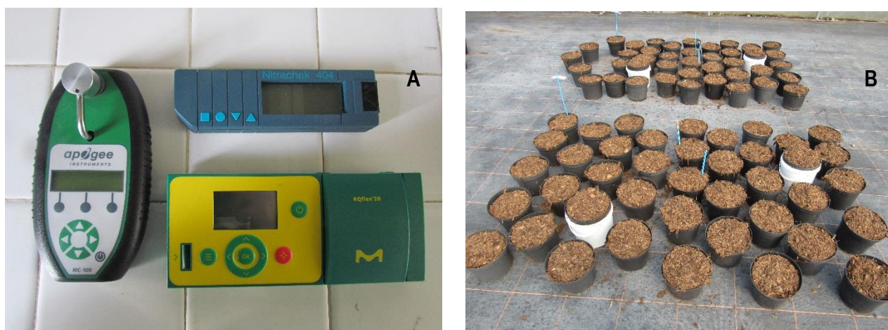
Figure 1 : (A) Outils de pilotage utilisés pour suivre in situ les teneurs en azote nitrique (boîtier Nitrachek®), en azote ammoniacal (boîtier RQFlex®) dans les supports de culture et la teneur en chlorophylle des feuilles (pince à chlorophylle MC-100), (B) Dispositif expérimental in situ sous abri avec des pots sans plantes
