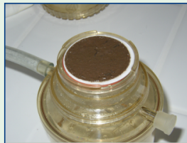
Filtration sous vide
