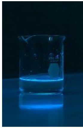
Figure 1 Fluorescence d'azurants optiques contenus dans un bécher, exposés à des rayonnements ultra-violet (Source : Antoine TOURRET)
