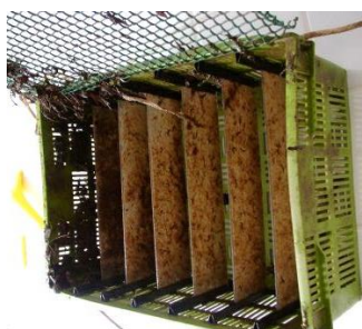
Figure 9 : Cagette contenant les lames de verre pour la colonisation du biofilm
