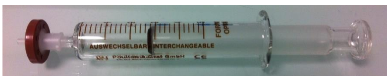
Figure 27 : Seringue en verre de 5 mL et filtre Whatman Spartan 13
