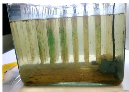
Figure 10 : Aquarium pour la colonisation des coupons
