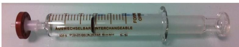
**Figure 27 : Seringue en verre de 5 mL et filtre Whatman Spartan 13**
