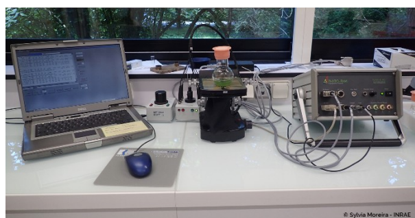
Figure 4 : Equipement pour les analyses de fluorimétrie en lumière modulée (Phyto-PAM).
