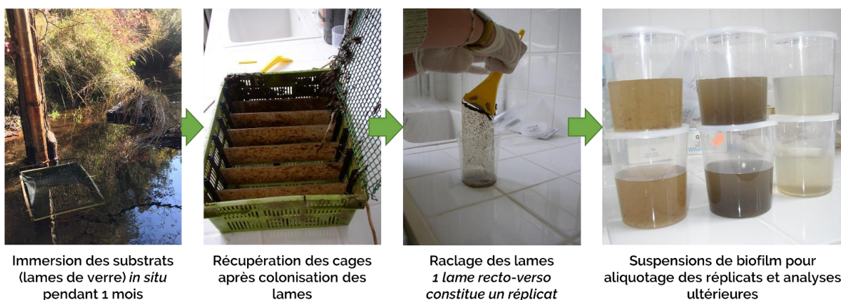
Figure 3 : Protocole de récolte du biofilm et devenir des échantillons.
