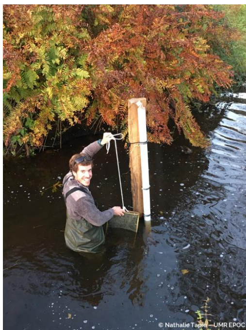
Figure 2 : Installation des substrats artificiels sur le terrain.
