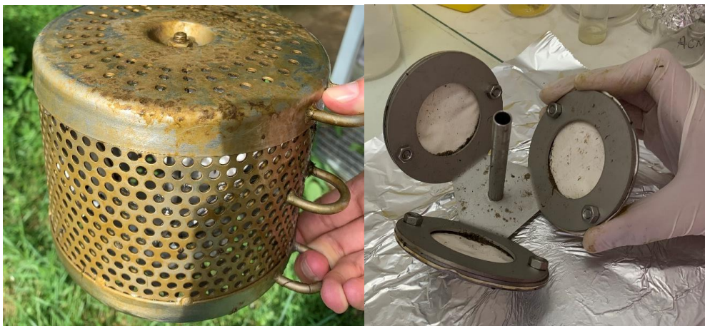
Figure 5. Photo de POCIS lors de leur démontage et cage à POCIS après 14 jours d'exposition dans l'Orgeval
