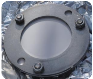
Mesure de l'exposition : POCIS (Polar Organic Chemical Integrative Sampler) (n cherché = 42)
