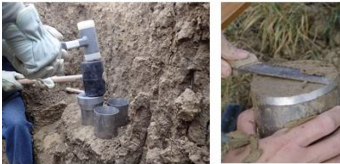
Figure 5 : Méthode de prélèvement de sol au cylindre pour la mesure de masse volumique
