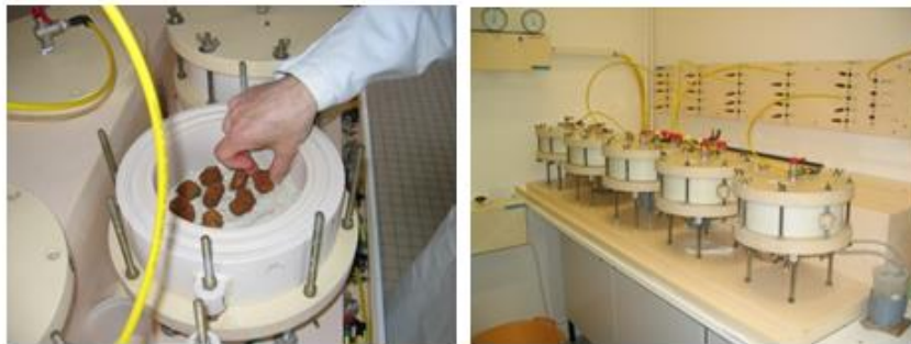
Figure 7 : Mesure au laboratoire des propriétés de rétention en eau sur les mottes de sol prélevées sur les fosses pédologiques
