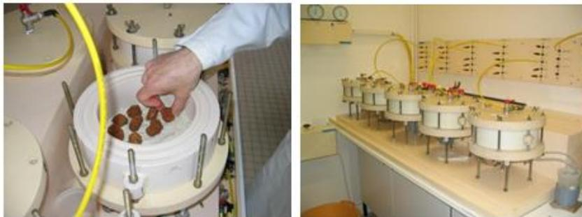
**Figure 7 : Mesure au laboratoire des propriétés de rétention en eau sur les mottes de sol prélevées sur les fosses pédologiques**
