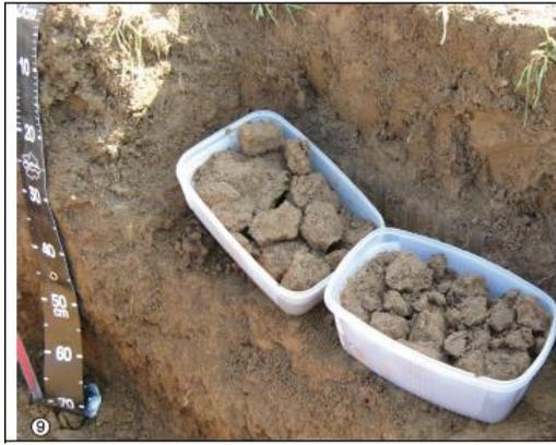
**Figure 6 : Prélèvement de mottes de sol pour la mesure de teneurs en eau à potentiels hydriques connus au laboratoire**
