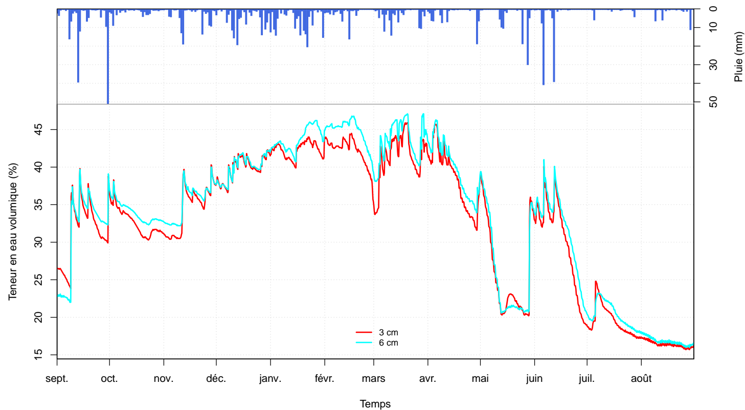
FIGURE 27 – Humidité du sol à la station météorologique CHEVRU-TP et pluie moyenne sur le bassin.
