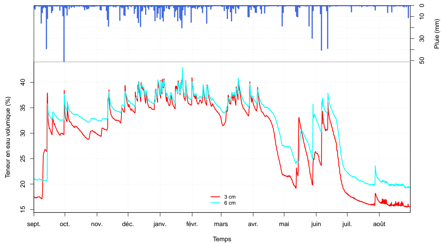
FIGURE 28 – Humidité du sol à la station météorologique ESTERNAY-TP et pluie moyenne sur le bassin.
