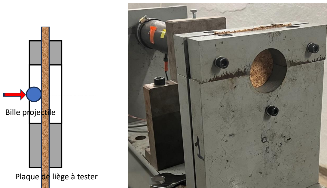
Fig 2.: Schéma et vue arrière des plaques de liège soumises à l'impact de bille
