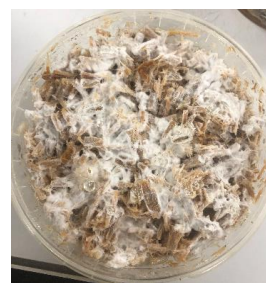
Fig. 6 : Mycocomposite hêtre natif avec ajout d'effluent du traitement hydrothermal.
