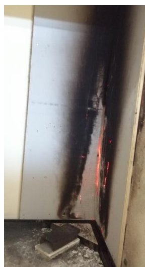
Fig. 7 : Panneau Alumine Zircone à la fin des essais SBI de réaction au feu.
