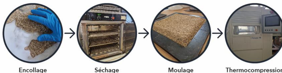
Fig. 2 : Processus de fabrication d'un panneau de Baccharis halimifolia depuis la phase d'encollage des fractions jusqu'à la thermocompression.
