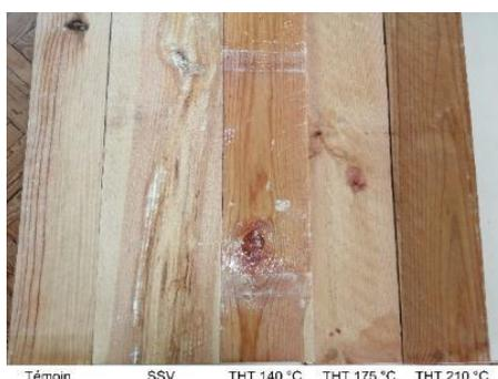
Fig. 2 : Photo des planches séchées et thermotraitées
