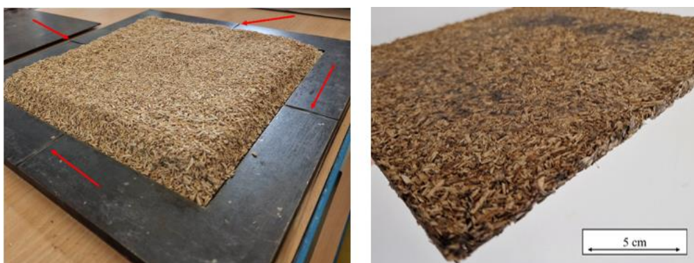
Fig. 5 : (gauche) Utilisation d'un moule usiné permettant l'évacuation du surplus de vapeur pendant la phase de thermocompression. (droite) Panneau GR-AB-3 obtenu de granulométrie 0,5 mm à 4 mm.
