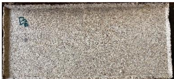
Fig. 1 : Aspect visuel du composite 80 % sciures – 20 % résine (WM)
