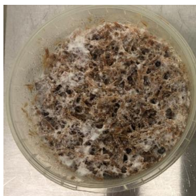
Fig. 5 Mycocomposite hêtre natif sans ajout supplémentaire
