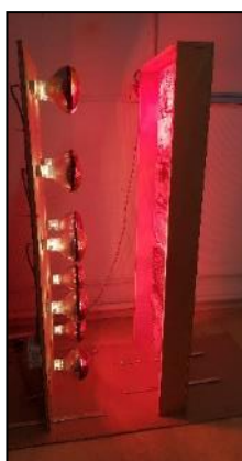
Fig. 1 : Dispositif d'exsudation ou « Exsudeuse »
