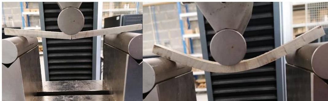
Fig. 4 : Flexion maximum observée lors de l'analyse des baguettes de bois non compressé (à gauche) et compressé à 20% (à droite).
