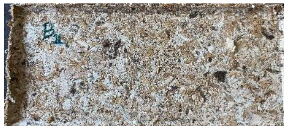
Fig. 2 : Aspect visuel du composite 26.6 % copeaux – 26.6 % sciures -26.6 % résidus agroalimentaires - 20 % résine (WM)
