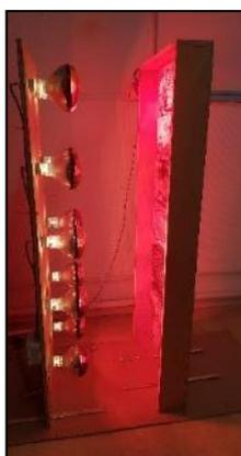
Fig. 1 : Dispositif d'exsudation ou « Exsudeuse »
