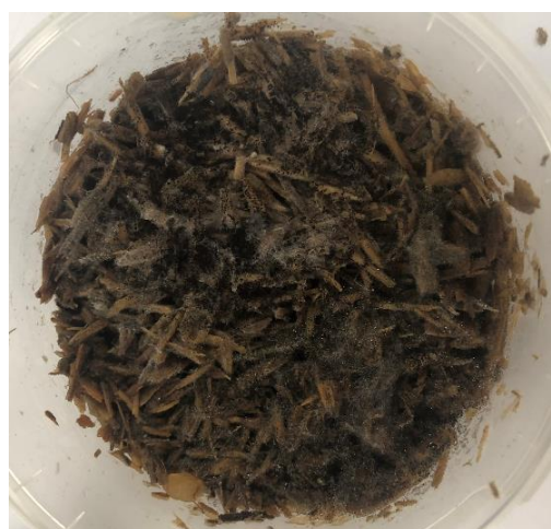
Fig. 8 : Mycocomposite avec du bois recyclé non traité
