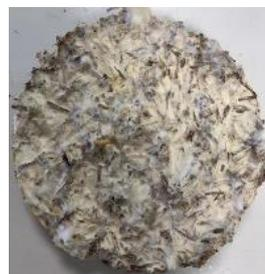
Fig. 2 : Mycocomposite à partir de biomasse prétraité
