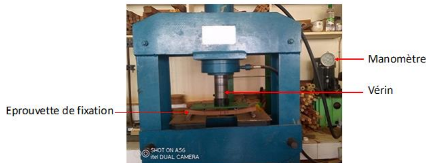
Fig.2 : Photo de l'éprouvette chargée en flexion quatre points.
