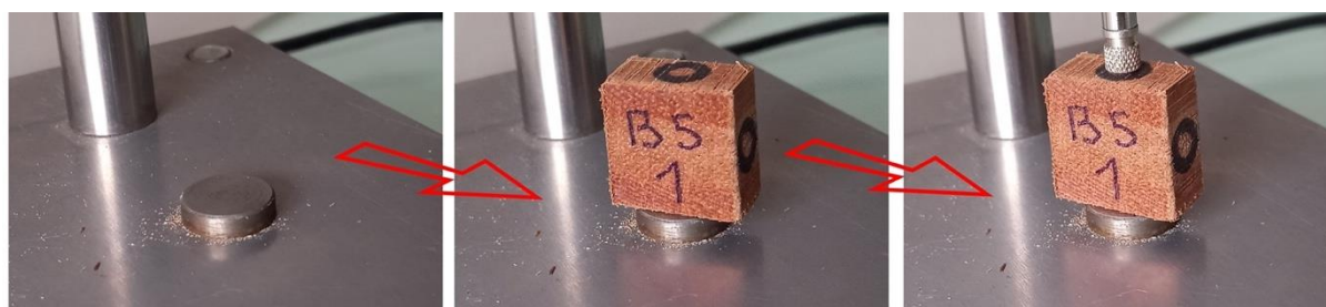
Fig. 3 : Mise en place de l'éprouvette et contact avec la touche plate du comparateur (Ø 5 mm)
