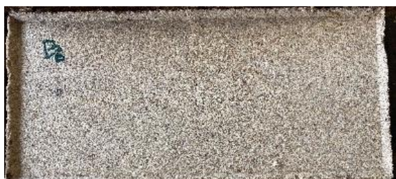
Fig. 1 : Aspect visuel du composite 80 % sciures – 20 % résine (WM)
