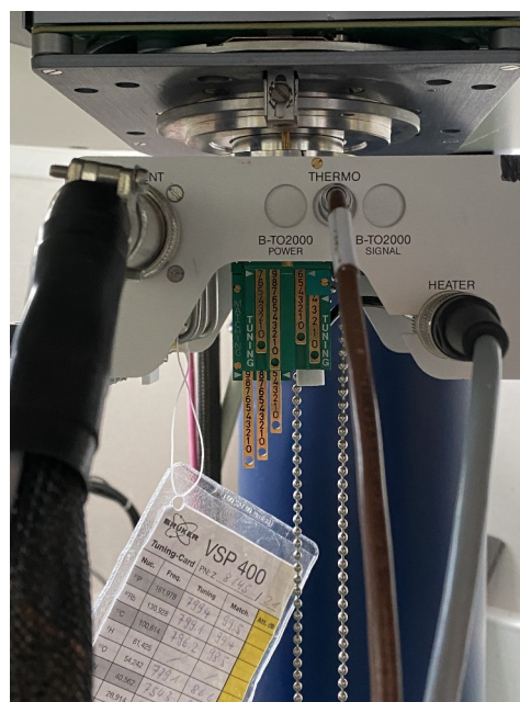
Figure 15: tirettes de "tuning" et "matching" pour l'accord sodium
