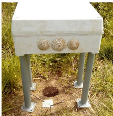
Dispositif de capture d'images en accéléré PiScope, basé sur un nano-ordinateur Raspberry Pi.
