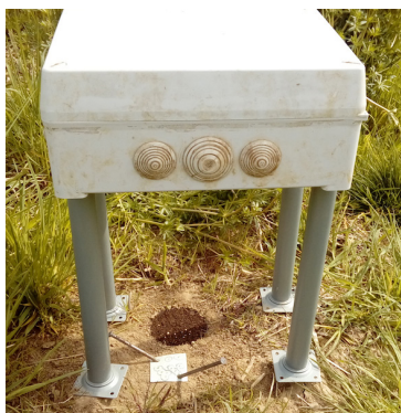
Dispositif de capture d'images en accéléré PiScope, basé sur un nano-ordinateur Raspberry Pi.
