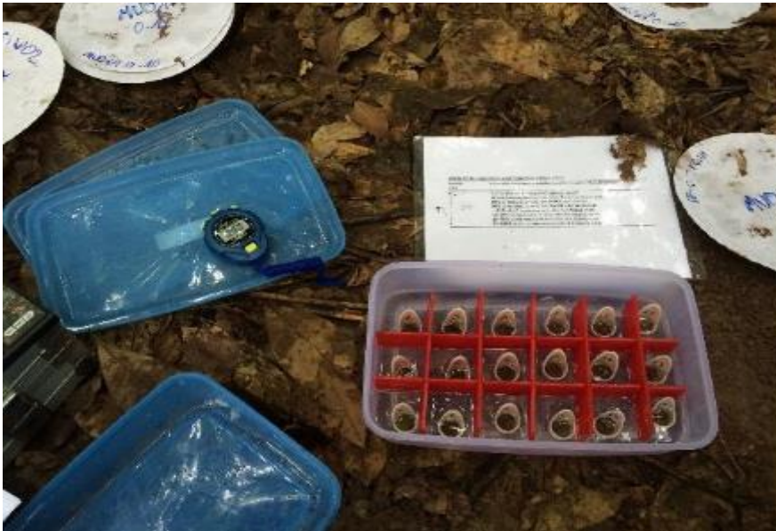
Photo 11 : Mesure in-situ de la stabilité des agrégats. 18 agrégats sont chronométrés en même temps pour l'attribution de leurs scores. 6 agrégats sont évalués pour le score d'une placette.
