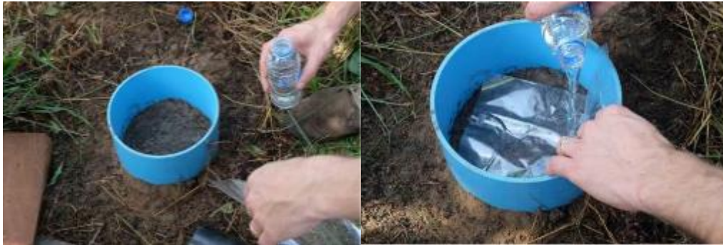
Photo 10 : Mesure de la capacité d'infiltration du sol (Beerkan).
