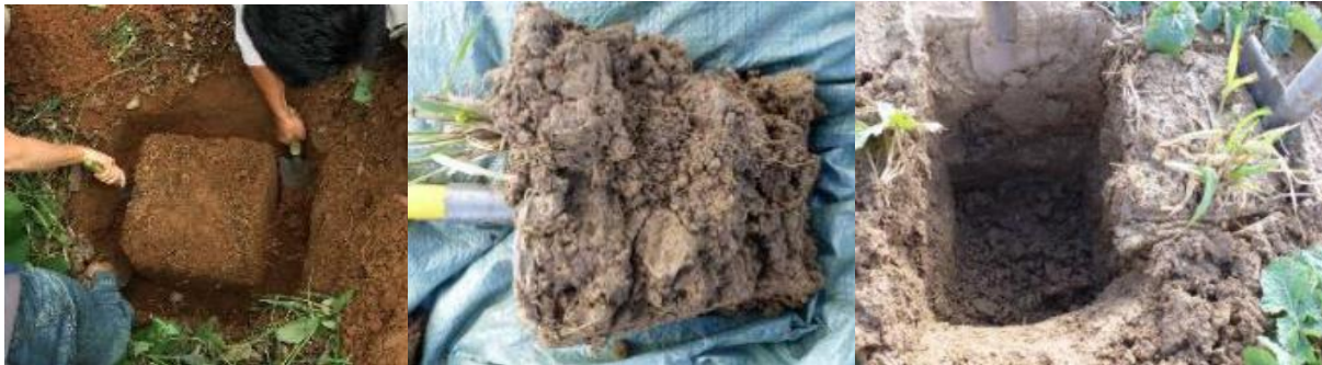
Photo 9 : Les différentes étapes pour exhumer un carré de sol de 20 cm*20cm.
