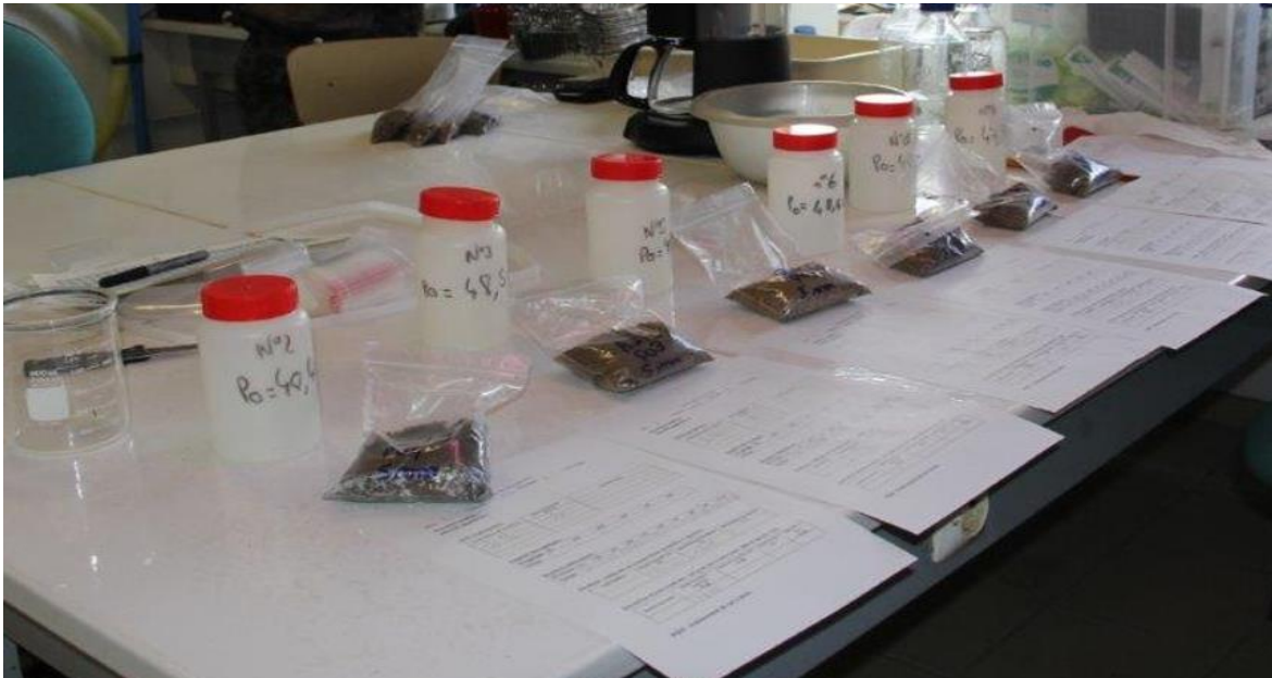
Photo 7 : Photo de la préparation des flacons et des échantillons de sol associés pour réaliser l'extraction avec le KCl.
