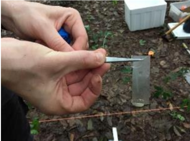
Photo 6 : Membrane échangeuse d'anions juste avant l'enfouissement. Chaque membrane est nouée avec du fil en nylon pour la récupérer facilement à la fin de l'incubation dans le sol.
