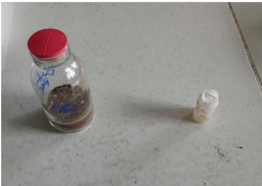
Photo 4 : Photo du matériel nécessaire pour mesurer la respiration basale du sol (SituResp). À droite, la cuvette est placée dans un contenant en plastique pour éviter le contact du gel et du sol.
