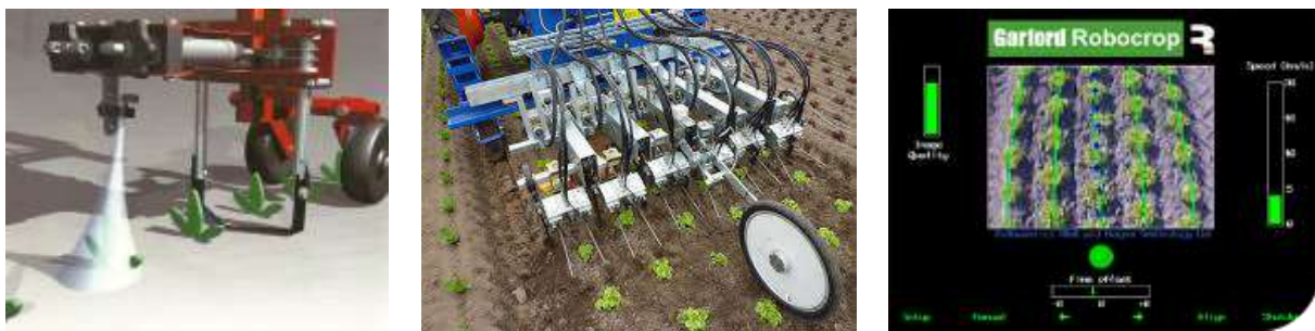
Figure 2 : Machines de désherbage sur le rang. De gauche à droite : principe du Steketee IC 2 , KULT Robovator 3 6 rangs, interface homme-machine du Garford Robocrop 4 .
