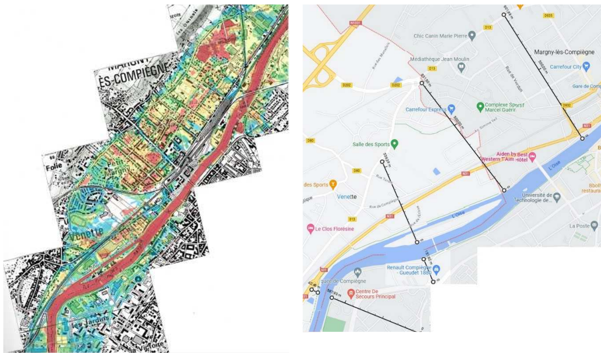
Figure 11 : Extension du lit majeur dans le secteur du barrage de Venette : a/ carte d'aléa du PPRi de la rivière Oise, secteur Compiègne (CarteZI_Lamagistere.png) ; b/ largeur en différents profils en travers (Lit MajeurOiseVenette.jpg)
