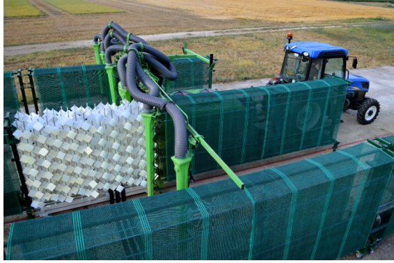
Photo 2 : Test d'un pulvérisateur face par face sur le banc EvaSprayViti
