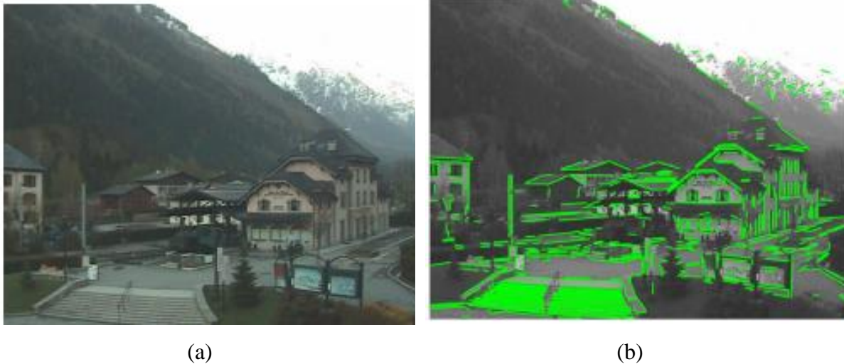
Figure 11 : Caractéristiques locales d'une image test : (a) image test (b) image avec segments de ligne LSD (Lin et al. , 2023)
