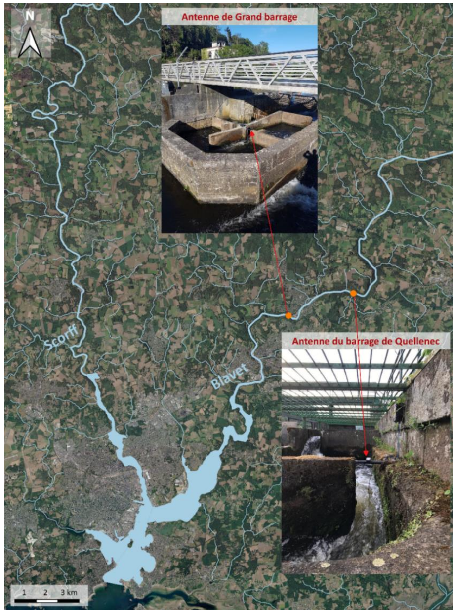
Figure 35 : Localisation des antennes RFID mises en place sur le Blavet.
