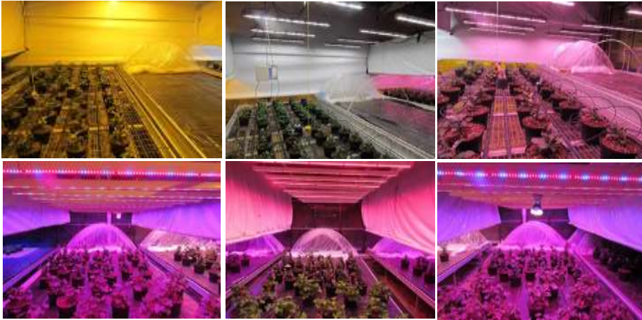
Figure 1 : Six systèmes d'éclairage photosynthétique évalués au sein d'ASTREDHOR Loire-Bretagne (Stepp) émettant différentes couleurs de lumière à intensité équivalente ( 70 \mu\text{mol}/\text{m}^2/\text{s} ) sur cultures de multiplication de Pélargonium et de Dipladénia. De g à d et de h. en b. : éclairage classique à haute pression sodium (HPS), LED VALOYA NS1, LED VALOYA AP67, PHILIPS DR/B 150, PHILIPS DR/W 150 et PHILIPS DR/W 150 + SPOT FR
