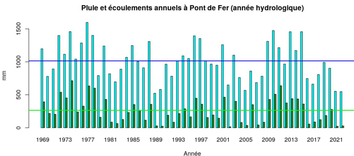
Figure 2 : Pluies et écoulements moyens annuels calculés sur l'année hydrologique (du 01/08/Année<sub>(n-1)</sub> au 31/07/Année<sub>(n)</sub>) du bassin de Pont de Fer (70 km<sup>2</sup>).
