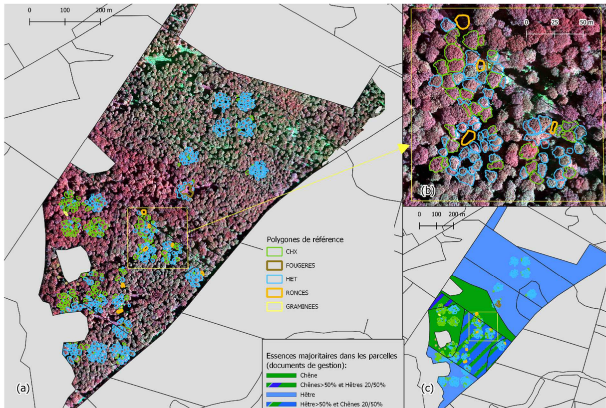
Figure 3 : (a) Partie de l'image multispectrale drone (composition NIR-R-G) sélectionnée pour l'étude et présentant les localisations des polygones de référence créés à partir des observations sur le terrain ; (b) Détail d'une zone où hêtres, chênes sont en peuplement mélangé ; (c) localisations des polygones de référence sur fond de la carte des essences majoritaires présentes dans les parcelles selon les documents de gestion.
