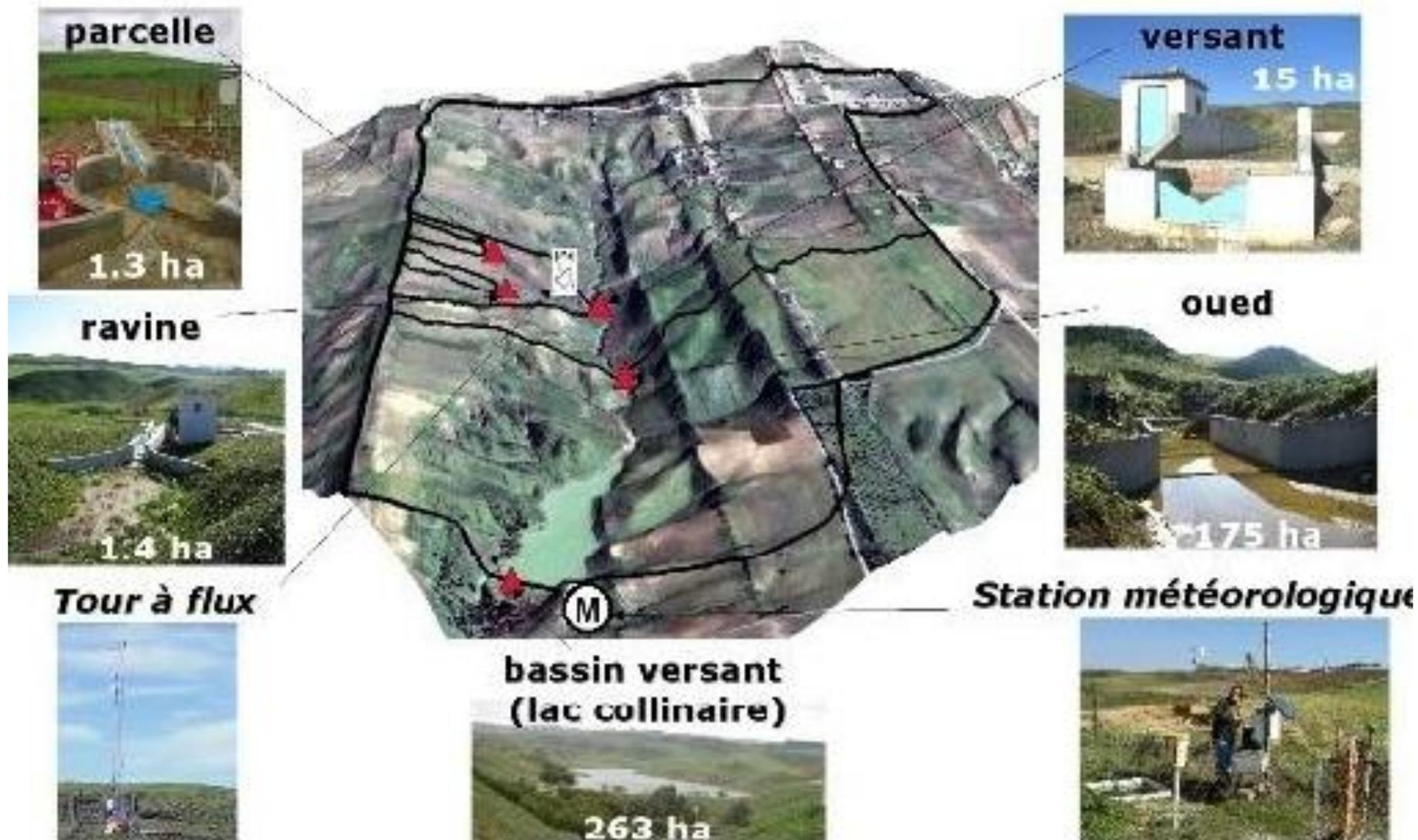
FIGURE 20: DISPOSITIFS DE MESURE INSTALLEE A KAMECH (DAMIER R., 2008)
