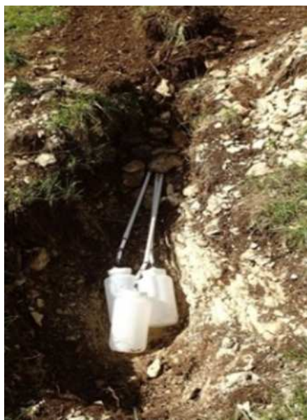
Lysimètre à plaques installé sous le mat racinaire (ci-dessus) et flacons permettant de recueillir les échantillons d'eau (à gauche) (E. Lucot)
