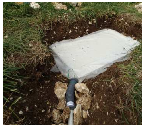
Lysimètre à plaques installé sous le mat racinaire (ci-dessus) et flacons permettant de recueillir les échantillons d'eau (à gauche) (E. Lucot)
