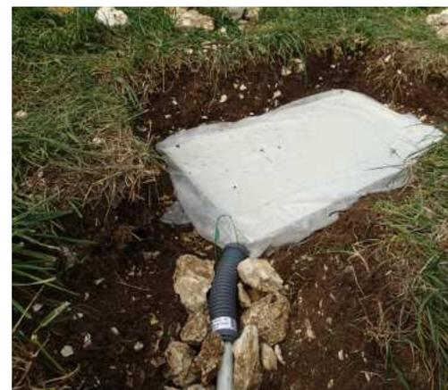
Lysimètre à plaques installé sous le mat racinaire (ci-dessus) et flacons permettant de recueillir les échantillons d'eau (à gauche)
