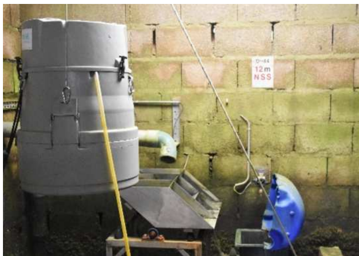
Equipement du collecteur d'une sous parcelle : auget basculant, bac de récupération et sa protection anti débordement (bleue), préleveur automatique
