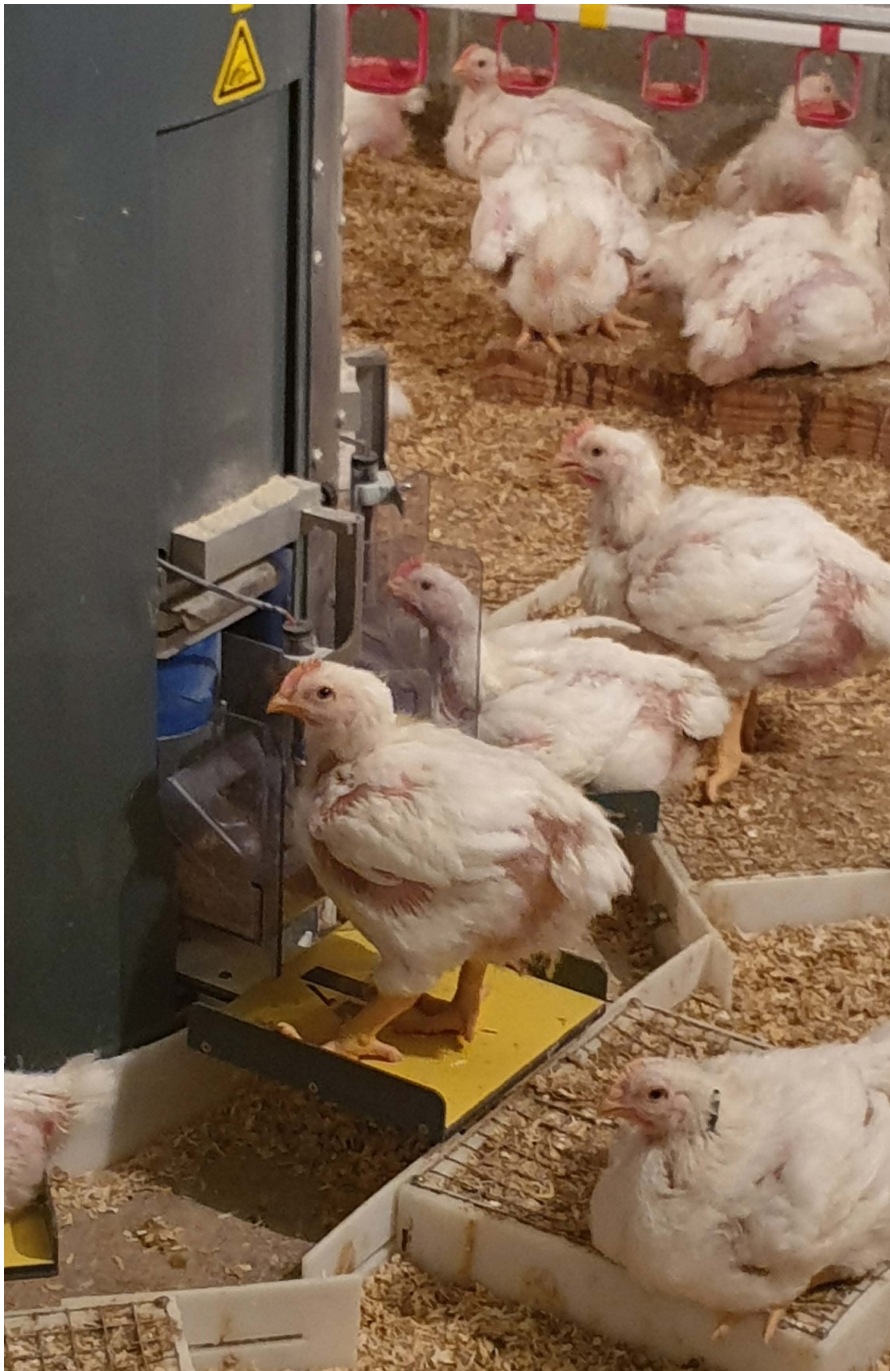
Figure 5. Mangeoire électronique permettant simultanément de peser les poulets et de calculer l'aliment consommé en temps réel, © INRAE.
