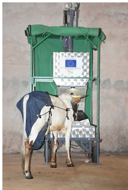
Figure 1. Taurillon zébu peulh soudanais au GreenFeed® pour la mesure du méthane entérique (Cirdes, Burkina Faso).
